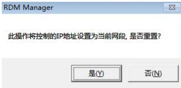
9. 控制器排序及重置 ID：在起始 ID 处输入重置的 ID，点击开始编址，编址成功后控制器的屏幕 ID 也会更改。
