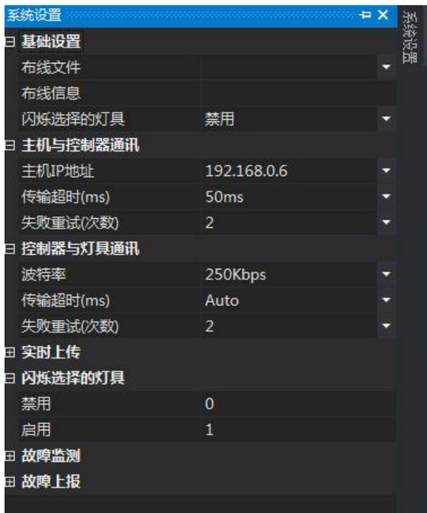
设置故障监测的参数，“控制器与灯具通讯”参数**用于设置控制器允许灯具应答的超时时间，auto 是按照标准 RDM 协议定义的最长应答时间，可下拉列表选择具体时间，增加对其他非标准 RDM 灯具的兼容性。**此外启动实时监测时，若有故障会上报至填写的邮箱，邮箱类型支持 163 与 QQ（注：**需要开启邮箱的 SMTP,参照 smtp 开启方法文档**）；
