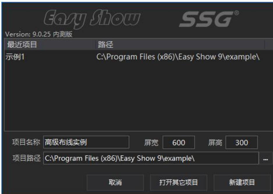
11. 点击新建项目后弹出高级布线新建信息文本框，输入新建布线文件的名称“高级布线显示屏\_1\_分区\_1”；
